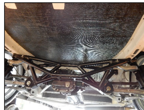
CS4 Structure supplémentaire - extérieur
