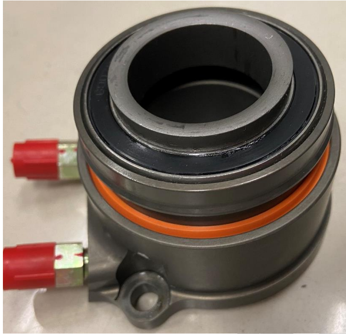
Nouvelle butée d'embrayage New clutch bearing
