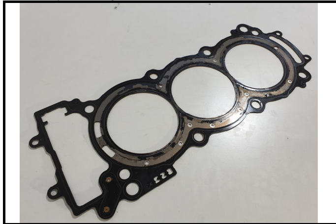
C8-14) Joint de culasse – déposé Cylinderhead gasket – dismantled
