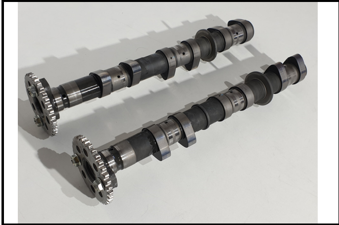
C10-5) Pignons arbres à câmes- démontés Camshafts gears - dismounted
