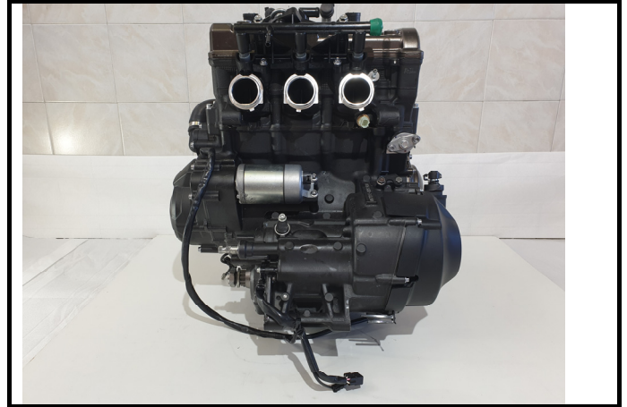
C1-4) Couvre culasse - déposé Cylinderhead cover - dismounted
