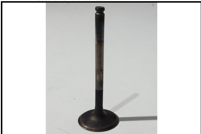
C12-1) Soupape échappement - déposée Exhaust valve - dismantled
