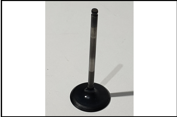
C11-5) Soupape admission - déposée Intake valve - dismantled
