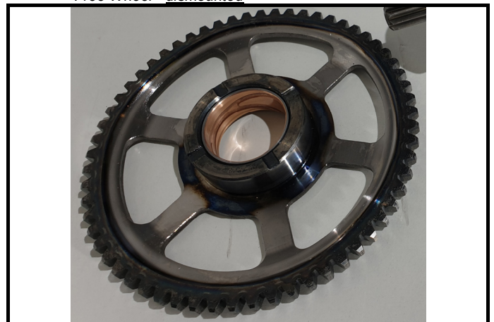
C16-2) Roue libre - déposée Free Wheel - dismounted
