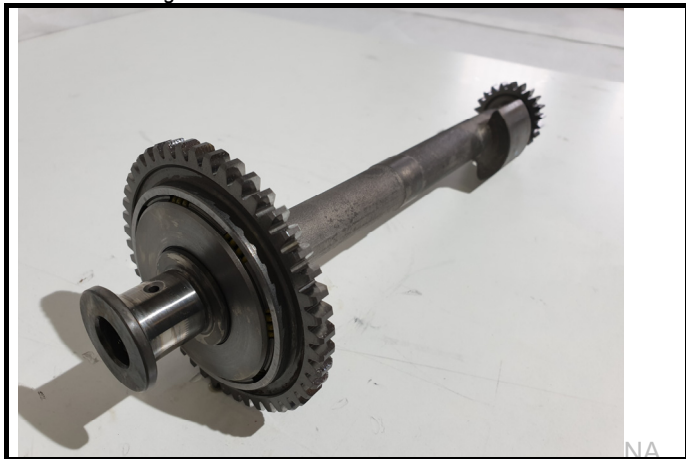
C3-9) Arbres d'équilibrage - démontés Balancing shafts - dismantled
