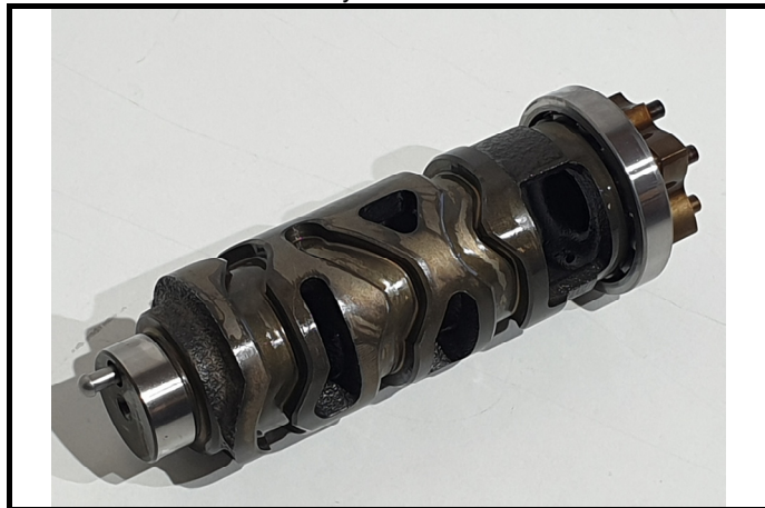
F9-5) Assemblage du barillet Selector barrel assembly
