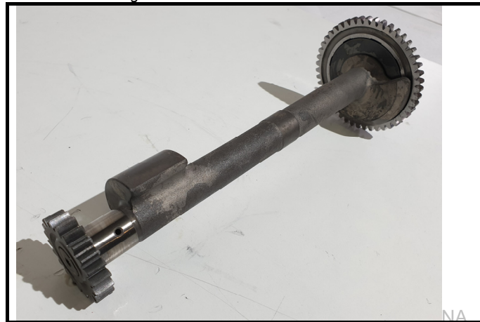
C3-10) Arbres d'équilibrage - démontés Balancing shafts - dismantled
