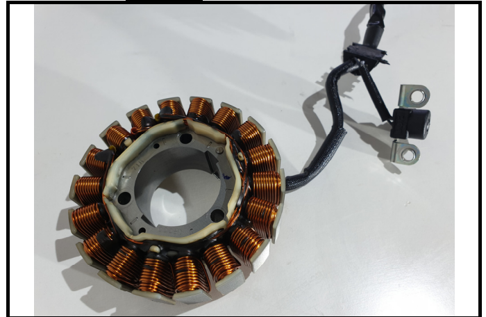
C15-2) Stator - déposé Stator - dismounted
